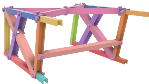
Rysunek 2.4: Rama platformy oparta o profile aluminiowe
